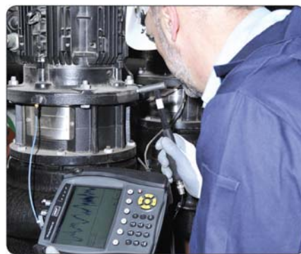
SKF マイクロログ AX は、素早くデータ収集し、解析する機器です。見やすく大型のモニターを備えています。
